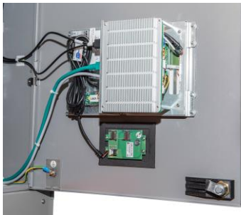
Das Schreib-/Lesegerät TWN4 MultiTech 2 BLE integriert in die myRENZbox ( briefkasten.de )
