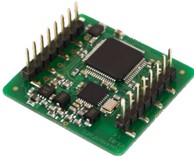
TWN3 Mini Reader MIFARE NFC top view*
